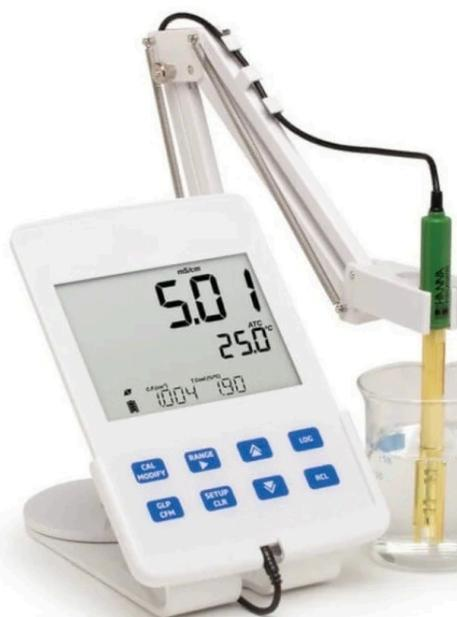
Intervalo CE: 0.00 a 29.99 S/cm, de 30.0 a 299.9 S/cm, de 300 a 2.999 microsiemens/cm, 3.00 a 29.99 mS/cm, 30.0 a 200.0 mS/cm, hasta 500.0 mS/cm (CE absoluta)
